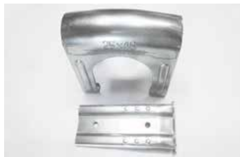
トップクロス(25φ×48φ) ZAM 補助アーチと外母屋の直管を固定するために使用します。
