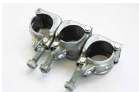
三連自在クランプ ZAM 連棟部の谷底の位置に 48.6 φの直管を通し三連自在クランプで固定します。
