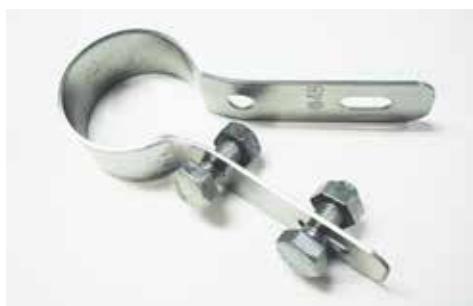
妻用ユニバーサル (48.6 φ) ZAM 妻用の角パイプを固定するときに本体と角パイプの先端ツブシ部分で取付けます。
